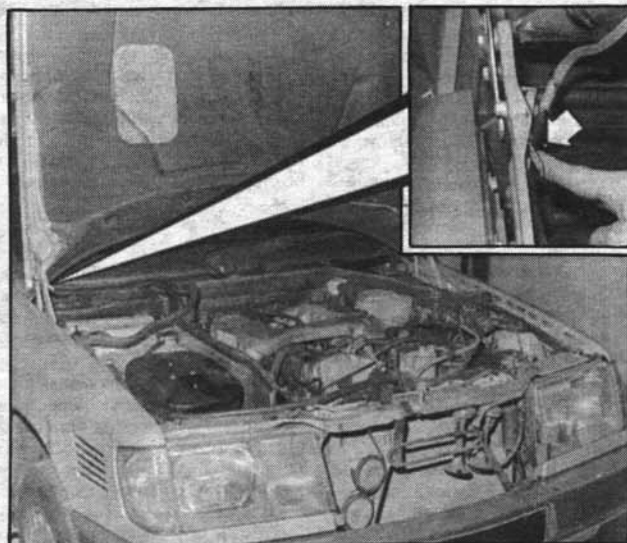
Подъем в вертикальное положение и разблокировка капота двигателя
