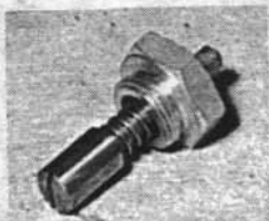
Приспособление для установки угла опережения подачи топлива топливным насосом высокого давления (601589 05 21 00)
