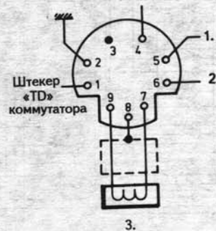
Условная нумерация штекеров колодки диагностики 1. Вывод «15» катушки зажигания 2. Вывод «+30» 3. Датчик ВМТ
