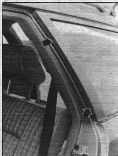
Винты крепления декоративной рамки бокового стекла багажного отделения универсала
