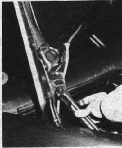
Три болта крепления двухзвенного шарнира капота (при разблокировке упора капот можно поставить вертикально вверх)
