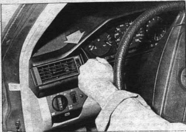
Установка крючка для снятия комбинации приборов
