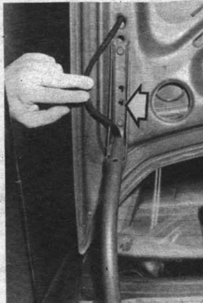
Болты крепления петель крышки капота (белой стрелкой показано установочное отверстие)
