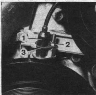
Снятие датчика ВМТ: 1 — датчик; 2 — гайка крепления; 3 — фланец
