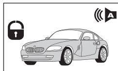
Система снята с охраны и замки дверей автомобиля открыты
