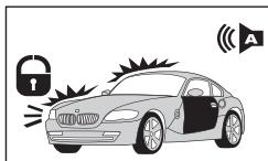
Система сработала от концевого выключателя капота
