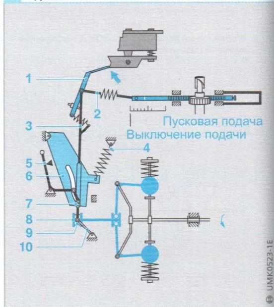
25 Всережимный регулятор типа RQV..К (подача топлива при полной нагрузке на низкой частоте вращения). Начало фазы отрицательного корректирования крутящего момента двигателя
