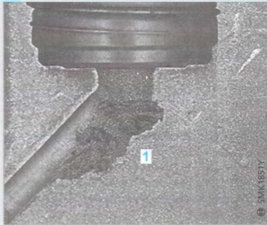
1 Кавитационное повреждение в распределительной головке ТНВД VE
