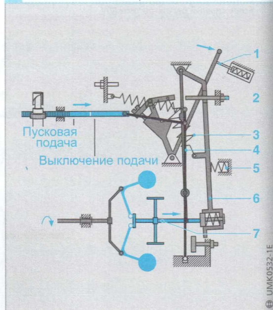
31 Всережимный регулятор типа RSV в положении минимальной частоты вращения холостого хода
