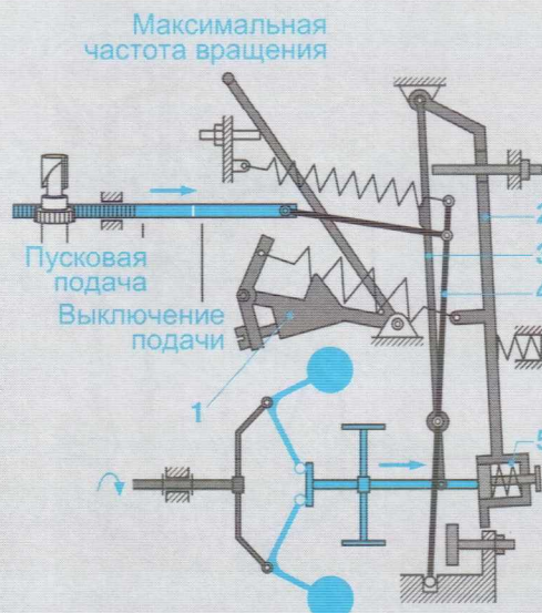
34 Всережимный регулятор типа RSV (регулирование максимального скоростного режима — «полная нагрузка — полный сброс нагрузки»)
