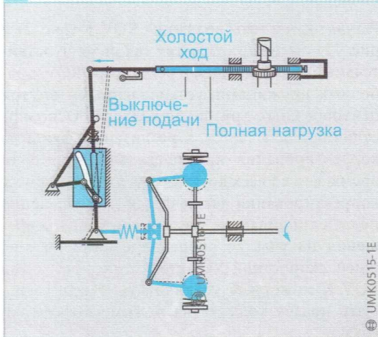
18 Всережимный регулятор типа RQUV на режимах полной нагрузки, пуска двигателя и регулирования максимального скоростного режима
