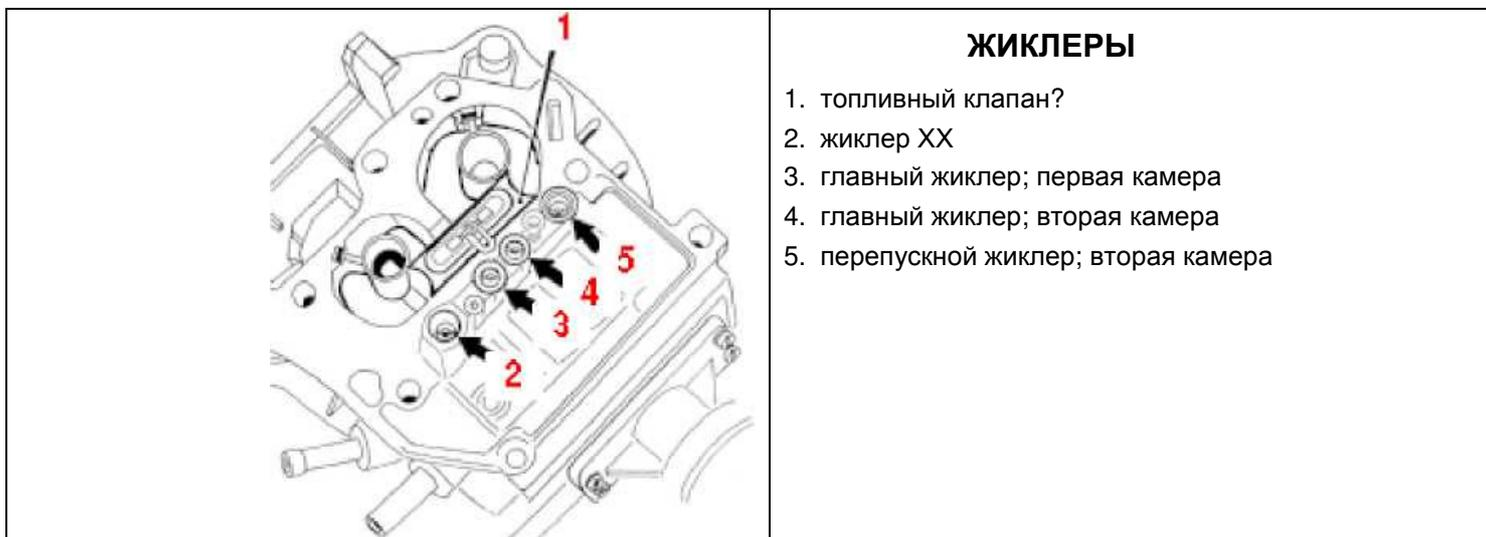
Это двухкамерный карбюратор. Карбюратор не содержит: пусковой системы; системы обогрева, насоса-ускорителя. Карбюратор не имеет клапана отсечки топлива. Карбюратор оборудован: воздушной заслонкой, управляемой шаговым двигателем и электропневматическим приводом дроссельной заслонки. Обе системы управляются электронным управляющим устройством (блоком управления – БУ, electronic control unit – ECU), положения заслонок определяются в зависимости от входных и выходных сигналов.
